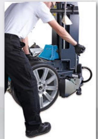
Die MS 650 ist eine pneumatische Reifenmontiermaschine mit kippbarer Montagesäule für PKW und besonders geeignet für Reifenspezialisten und Werkstätten mit hohem Auftragsvolumen.
